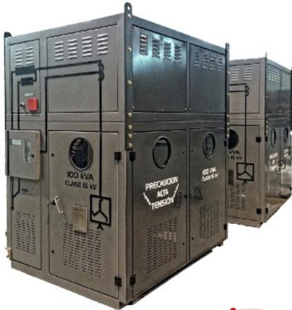
El sistema de puesta a tierra RGZ tiene como función principal el de generar un punto de neutro en sistemas conectados en delta mediante un transformador zig-zag. Una vez generado el neutro, una resistencia de bajo valor óhmico se conecta entre el neutro del zig-zag y tierra con el objetivo de limitar a un valor seguro la corriente de falla fase-tierra cuando ésta ocurra en algún punto del sistema de potencia.
